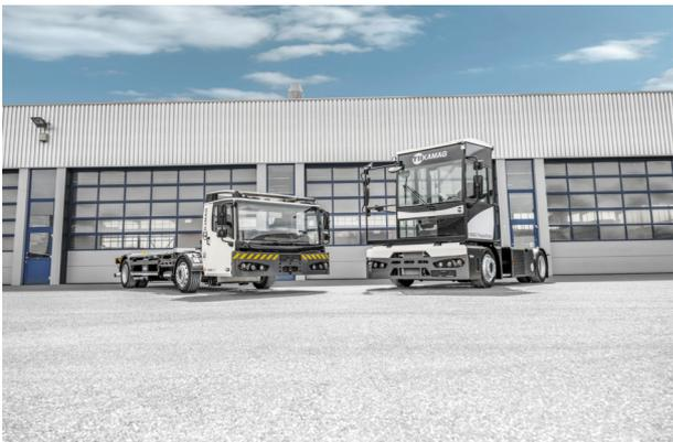
KAMAG Wechselbrückenhubwagen „PrecisionMover“ (PM) und Terminal-Zugmaschine „PrecisionTractor“ (PT)
