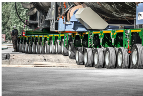
Der Achsausgleich der SCHEUERLE InterCombis helfen bei der Ballastierung auf dem Ponton.
