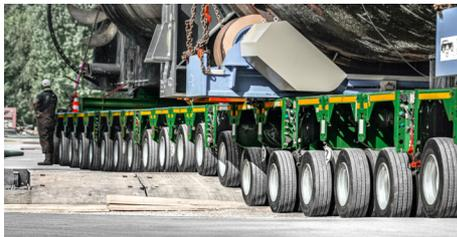
Le débattement des SCHEUERLE InterCombi est utile pour le ballastage sur la barge.
